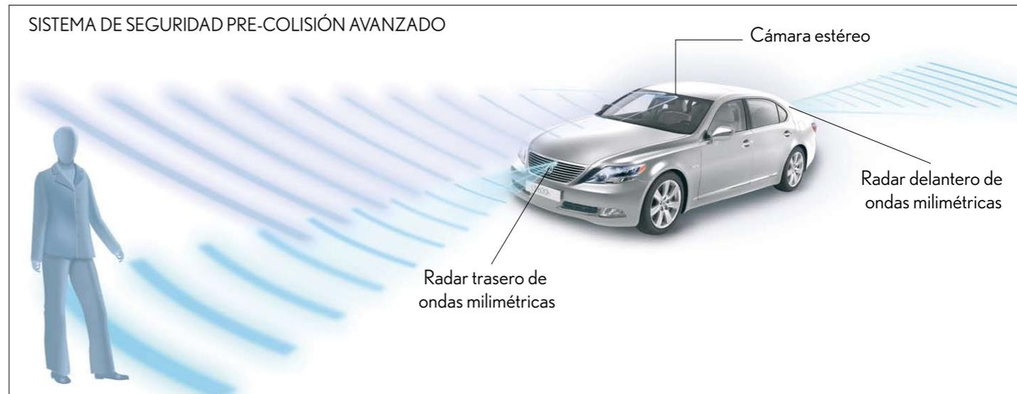
de 15 grados cuando se detecta un obstáculo en la carretera, el sistema activa automáticamente la función de señal acústica de aviso pre-colisión y aplica brevemente los frenos para alertar al conductor acerca de la situación.
