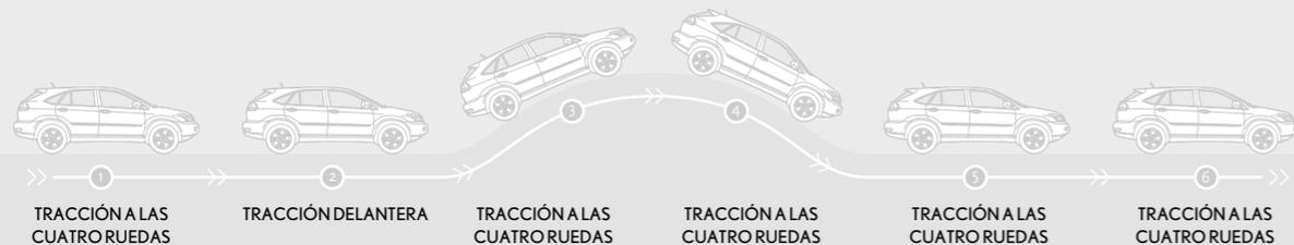
**1. Arranque** - Sólo se utiliza el motor eléctrico para el arranque y las bajas velocidades.
