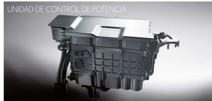
al tiempo que lo han mejorado sistemáticamente para aumentar al máximo la potencia del motor eléctrico. La construcción exclusiva de la generación más reciente de esta unidad sumamente compacta genera niveles mínimos de vibración y de ruido, y tiene el tamaño de una batería auxiliar de 10 litros.
